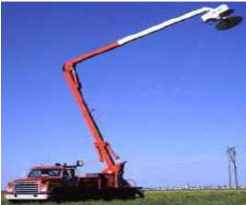
Figure 20: un capteur au sol placé sur une grue.
