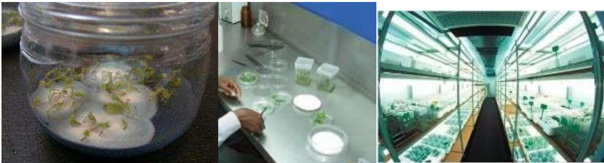
Figure 3 Conditions stériles ; a : vitroculteur, b : Hotte à flux laminaire, c : chambre climatisée.
